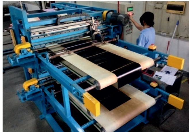
Maszyna do Kalandrowania Materiału / Rollers Calendering for Fabric
