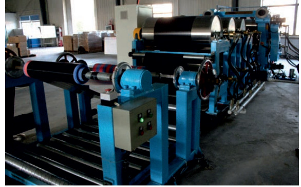
Maszyna do Kalandrowania Materiału / Rollers Calendering for Fabric
