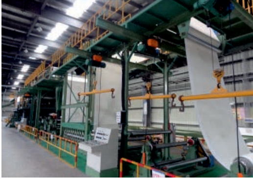
Maszyna Kalandrująca Gumę / Rollers Calendering for Rubber
